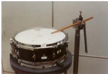
Abbildung 4: Detailaufnahme von Ständer und Anschlagvorrichtung
