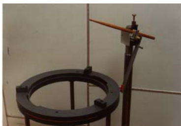
Abbildung 5: Detailaufnahme von Ständer und Anschlagvorrichtung
