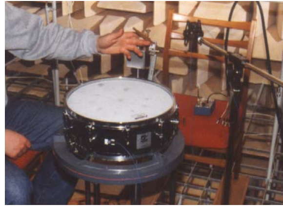
Abbildung 6: Messapparatur im reflexionsarmen Raum
