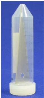
**Abbildung 3: Verwendete Gefäße zur Lagerung der Proben in der Prüflösung**
