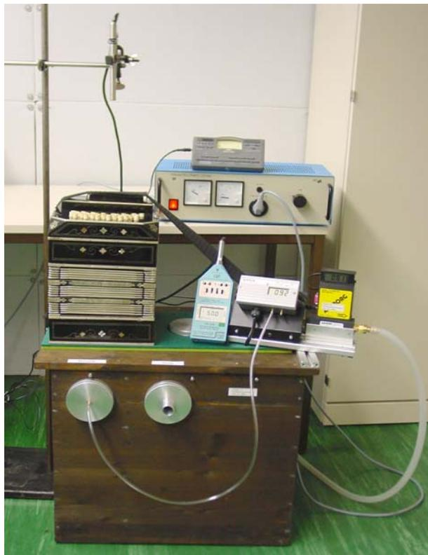
Bei der Mundharmonika erfolgen die Klangaufnahmen mit einem Messmikrophon in 1000 mm Abstand senkrecht über den Tonkanal.
