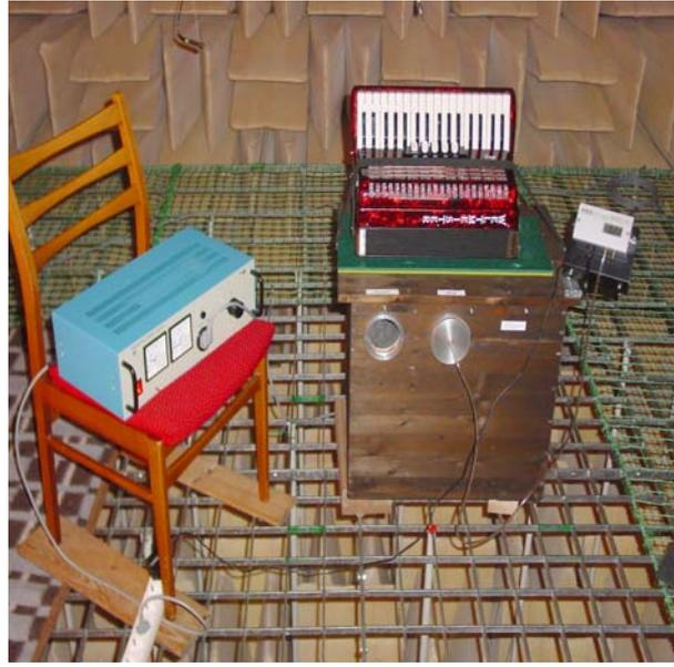
Der Spielwinddruck wird über die Drehzahl des Gebläses mittels Regeltransformator auf den vorgegebenen Prüfdruck eingeregelt. Dieser wird mit einem Druckmessgerät SET- D267 LD-
