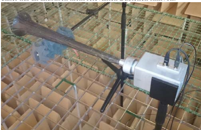
Abbildung 2: Messung der Schallabstrahlung eines Carbon-Versuchsschallstücks
