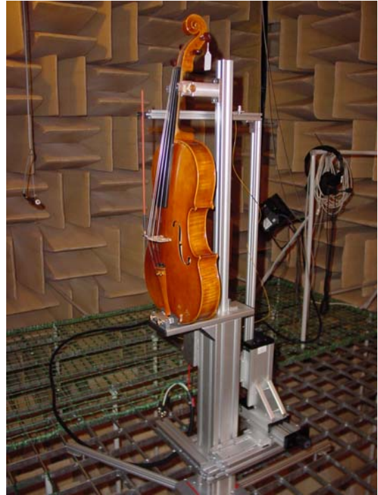
Abbildung 10: heutige Messvorrichtung für Geigen im reflexionsarmen Raum des IfM
