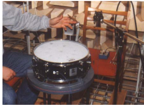
Abbildung 6: Messapparatur im reflexionsarmen Raum
