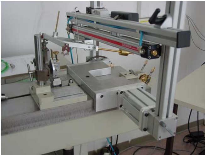
Abbildung 8: Messvorrichtung mit abgenommenem Bogen und eingesetzter Zupfvorrichtung
